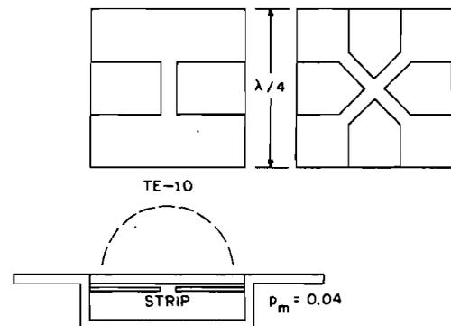
Fig. 12. Flush strip inductor.
