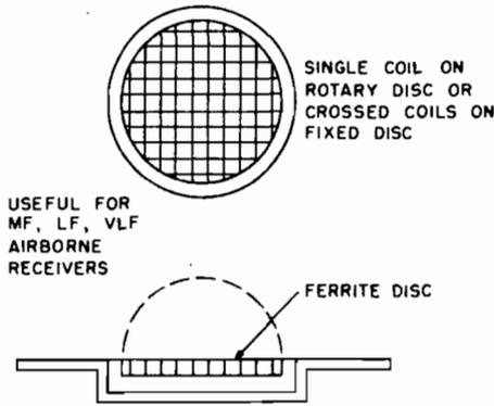
Fig. 13. Flush inductor on thin ferrite disc.
